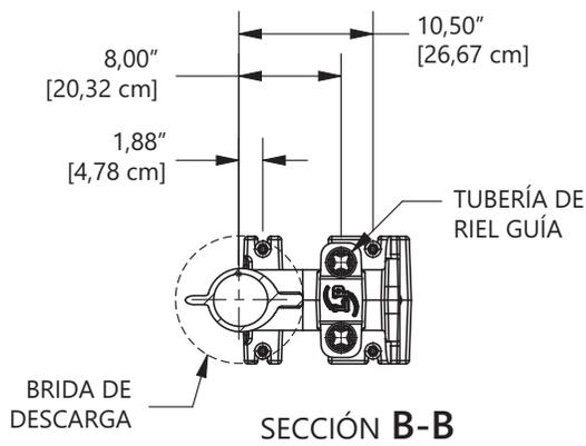
LÍNEA CENTRAL DE LA BRIDA DE DESCARGA AL PERNO DE MONTAJE
